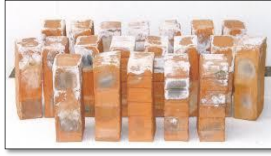
(d) Efflorescence observed after immersion
