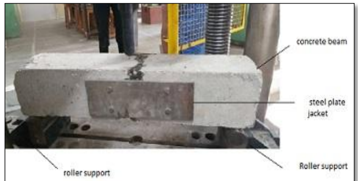
(b) Actual Testing of beam
